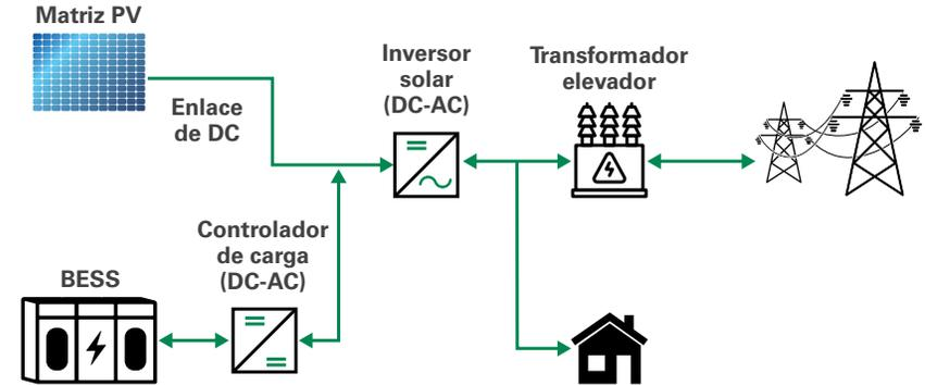
LEYENDA: PV = fotovoltaica DC = corriente continua AC = corriente alterna
