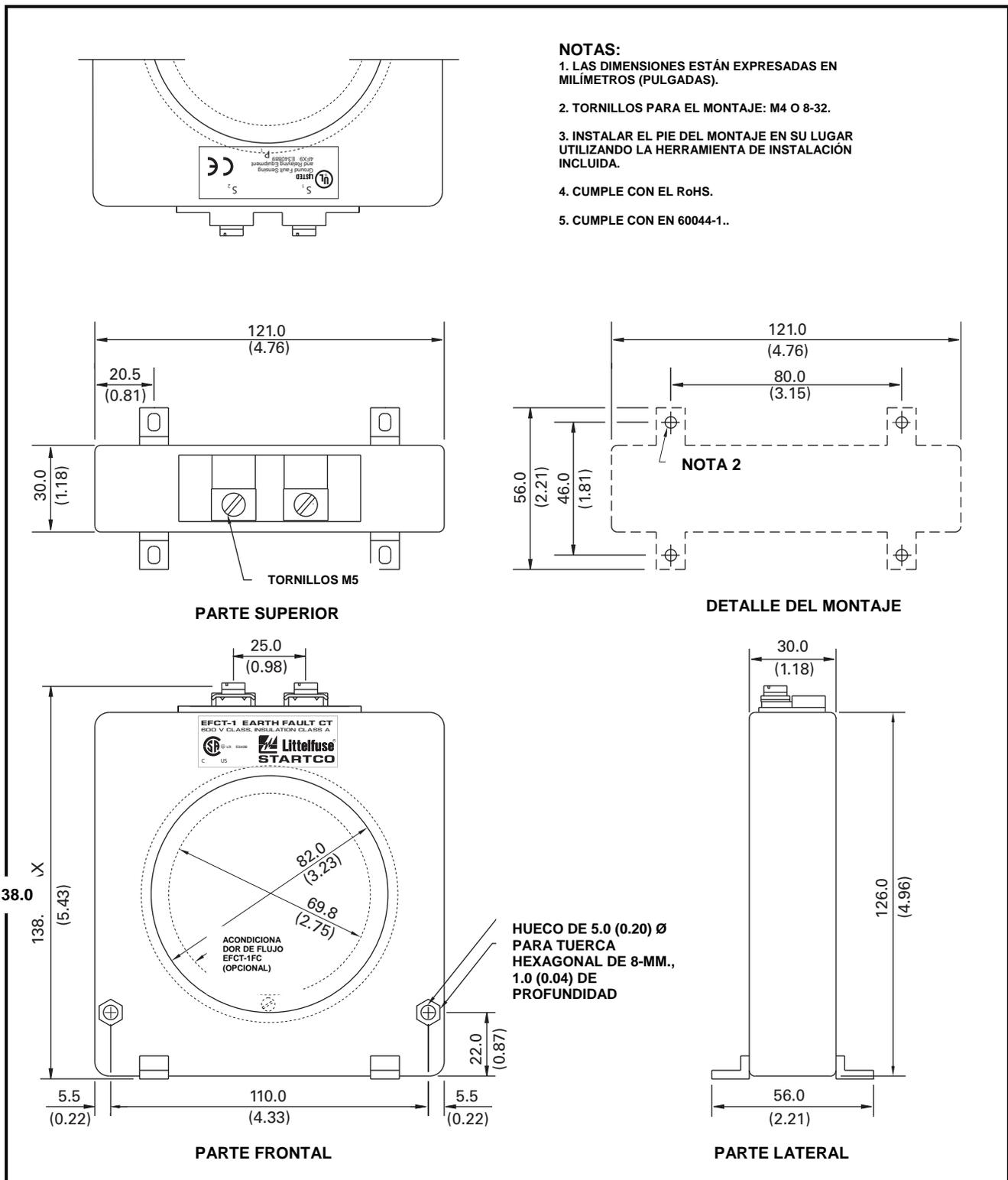
FIGURA 7. Esquema y detalles de montaje del EFCT-1
