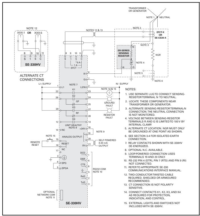
FIGURE 3. SE-330HV Connection Diagram.
