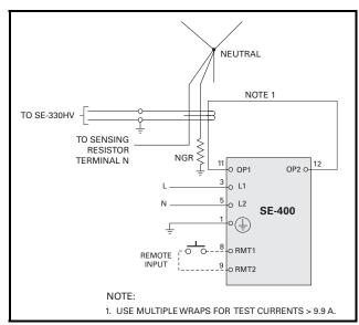
FIGURE 20. Ground-Fault-Test Circuit.
