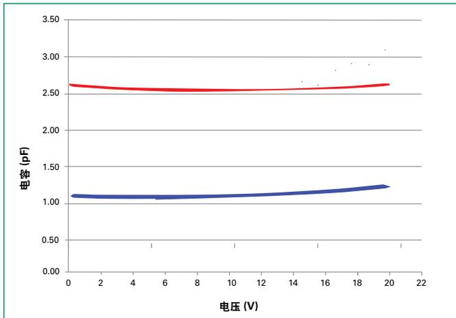
图1. 非偏置电容方差与线路电压的图表
