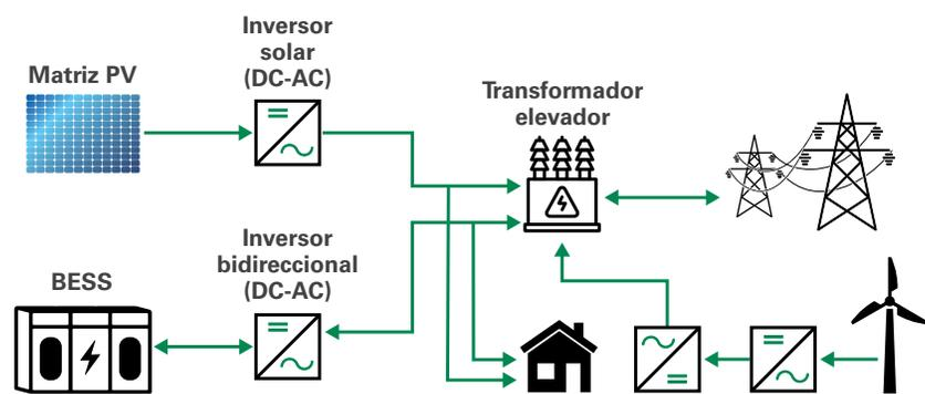
LEYENDA: PV = fotovoltaica DC = corriente continua AC = corriente alterna
