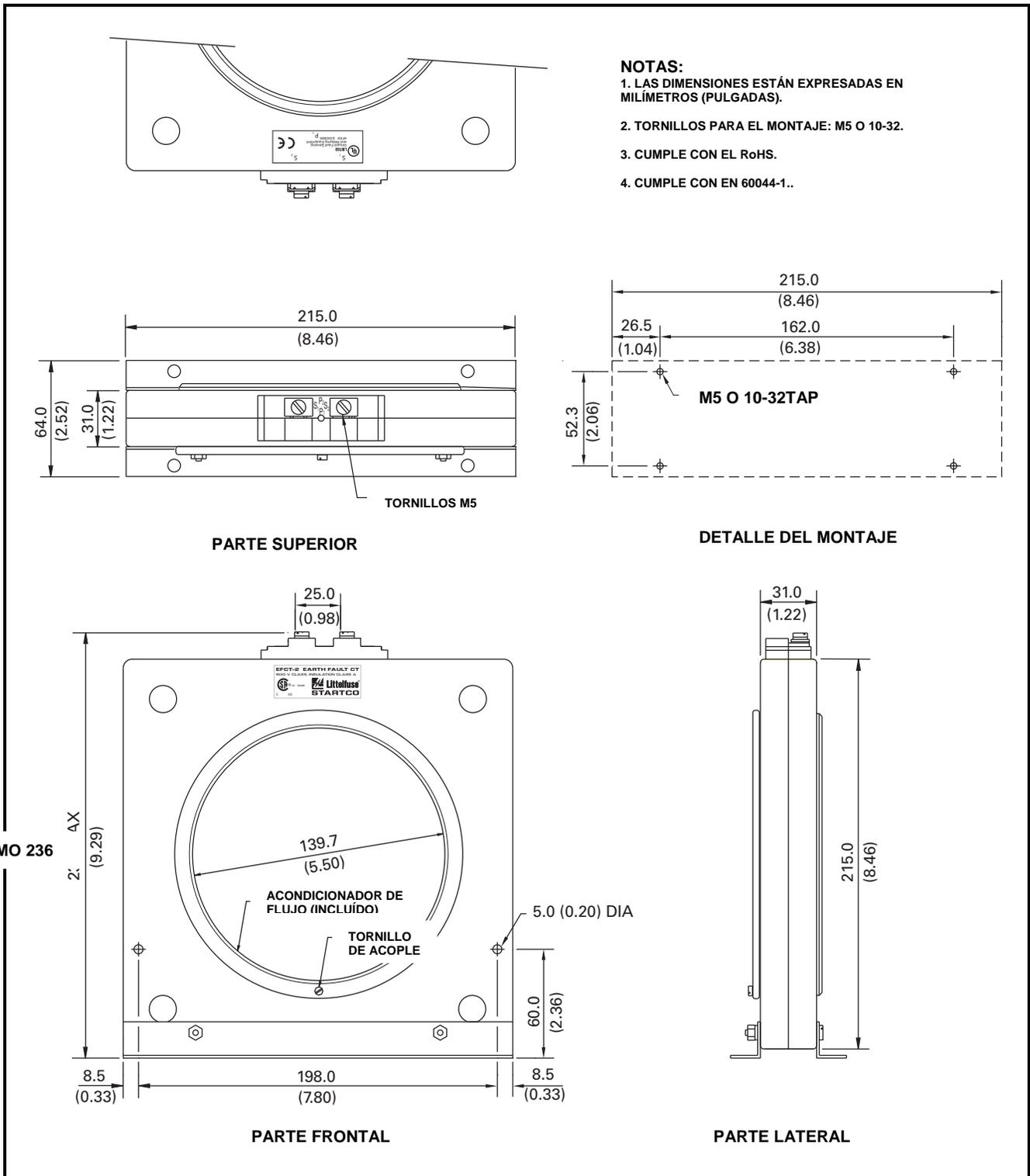
FIGURA 8. Esquema y detalles de montaje del EFCT-2
