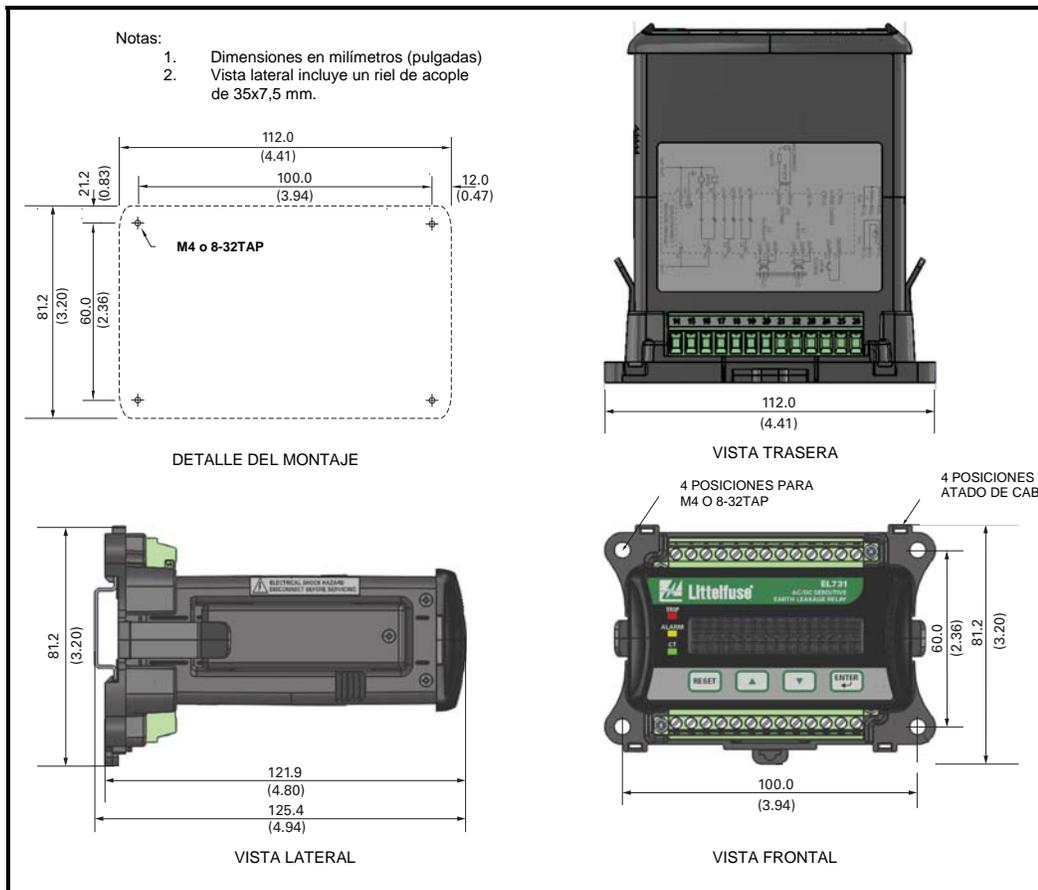
FIGURA 2. Esquema y detalles de montaje del AC700-SMK
