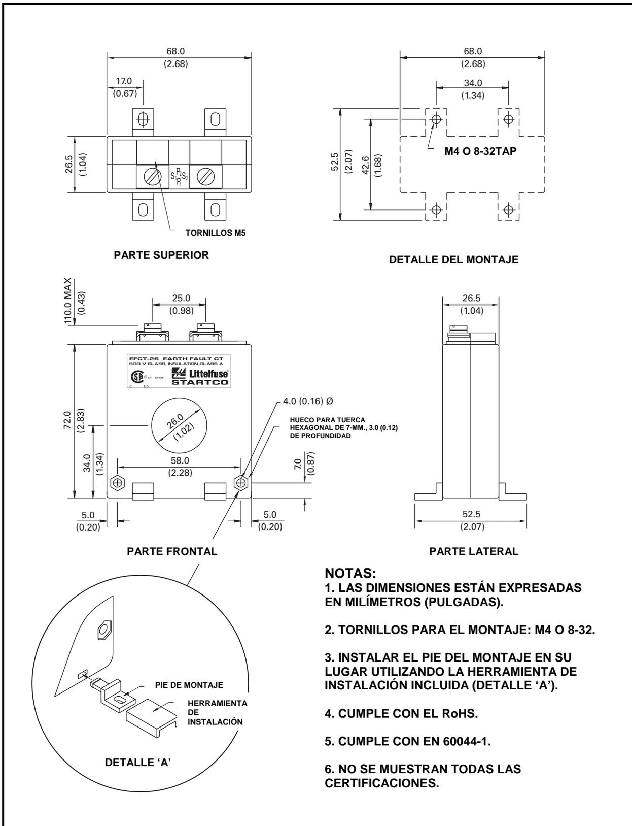
FIGURA 9: Esquema y detalles de montaje del EFCT-26
