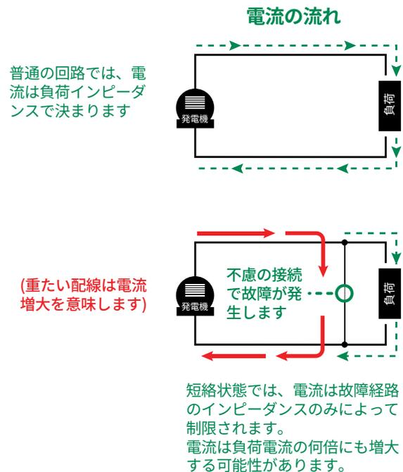
図 16 – 正常及び短絡における電流の流れ
