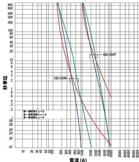
図5 - ヒューズ 3 種類の平均溶断時間比較
