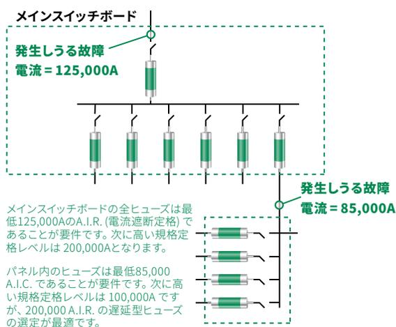
図 1 - NEC の遮断定格要求事項
