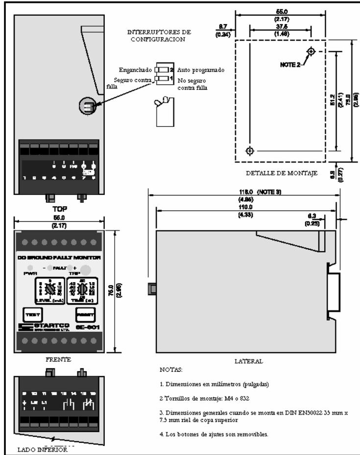
FIGURA 1, Detalles de trazado y montaje de SE-601
