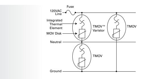
Figure 13. TMOV<sup>®</sup> varistor offline protection scheme.
